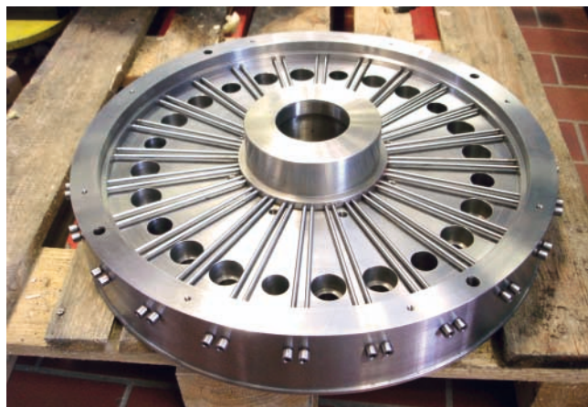
Bild 4. Aus einem Stück bestehende Coextrusionssscheibe mit integrierter partiell mehrwandiger Fließkanalwand und radial angeordneten Stellschrauben zur Feineinstellung des lokalen Fließkanalspalts im Bereich, in dem Mittel- und Innenschicht zusammenströmen
