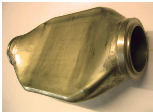
Bild 7. Drosselkörper mit den kontinuierlichen Übergängen von der mittleren flachen Fließkanalgeometrie auf die jeweils runde Ein- und Austrittsgeometrie
