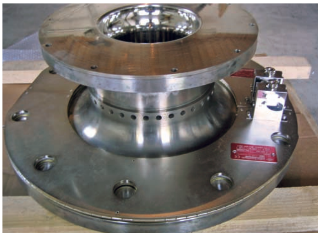
Bild 6. Aus einem Stück bestehendes Gehäuseteil mit flexibler Fließkanalwand und Gewindebohrungen über dem Umfang für die Einstellschrauben
