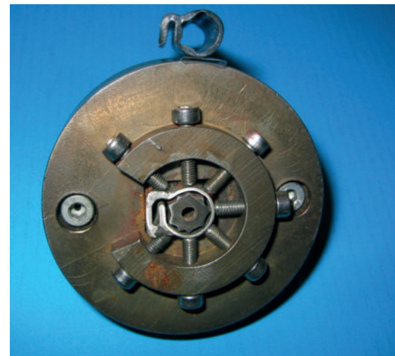
Bild 1. Flexringwerkzeug zur Herstellung eines Dichtprofils aus Silikon (Profilabschnitt liegt oben auf dem Werkzeug) mit einem Schnurdurchmesser von nur 9 mm
