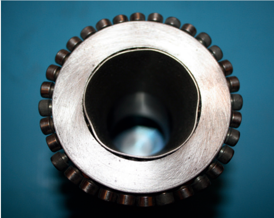
Runde Flexringhülse mit einem Durchmesser von 43 mm, die zu Demonstrationszwecken mithilfe von Stellschrauben rein linearelastisch deformiert worden ist
