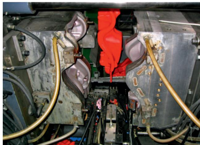
**Bild 1. Das Bobby-Car am Ende der Kühlzeit beim Austrag aus dem Werkzeug**
