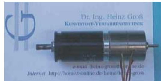
**Bild 7. Mit derartigen Kleinantrieben lässt sich die Verstellung der Stellschrauben von Flexringwerkzeugen automatisieren**
