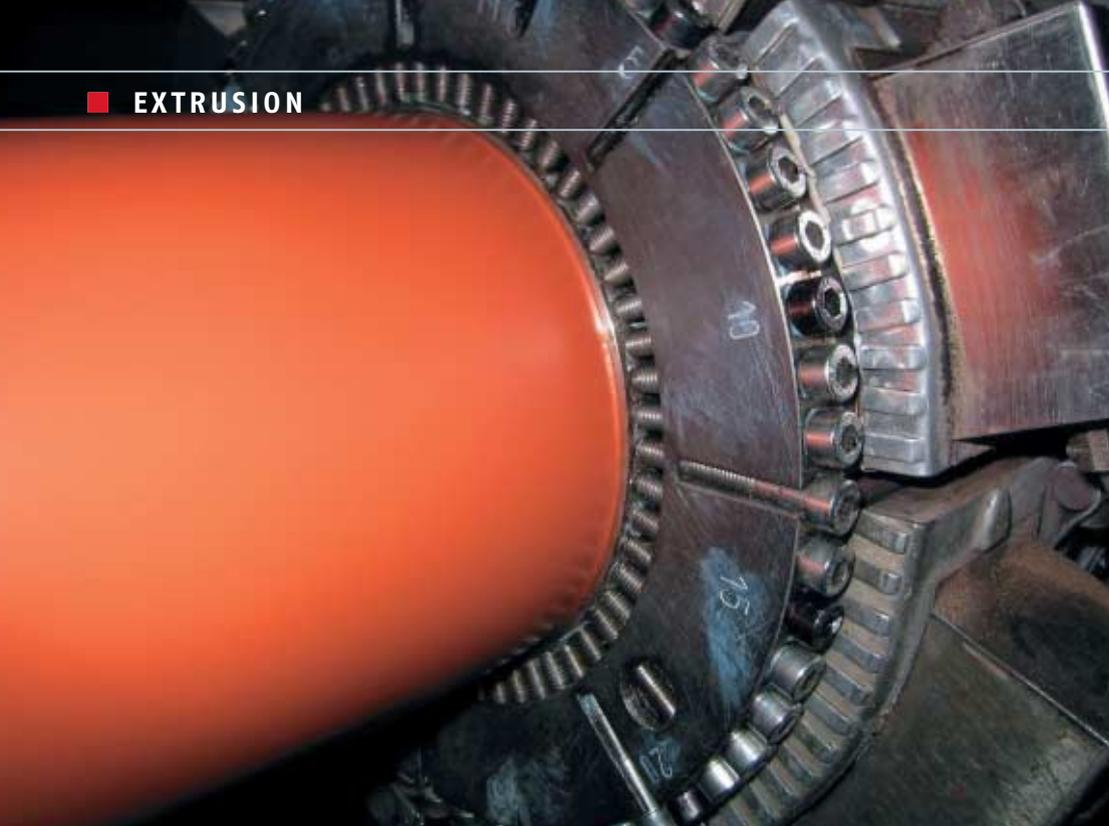
Rohrherstellung mit einem ursprünglich thermisch zentrierten Rohrwerkzeug: Die Optimierung des Fließkanalspalts mit Hilfe der 60 Stellschrauben ermöglichte eine Materialeinsparung von 250 g pro Meter Rohr
