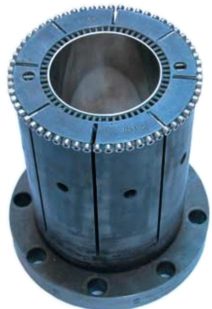
**Bild 1.** Der Außenring eines Rohrwerkzeugs mit Flexringhülse lässt sich durch Stellschrauben deformieren
