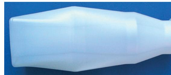
**Bild 6.** Mit dem Versuchswerkzeug hergestellte Flasche mit variierenden Querschnittsgeometrien (Foto: IKV)
