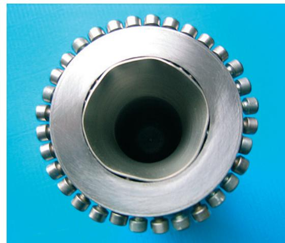
**Bild 1.** Testwerkzeug mit 32 Stellschrauben, bei dem die Flexringhülse zu Demonstrationszwecken in extremer Weise rein linear elastisch verformt worden ist
