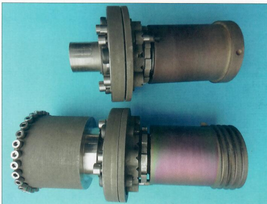
Bild 1: Zwei generativ hergestellte Mischschlauchköpfe für zwei Kunden, die entsprechend der unterschiedlichen Anforderungen konzipiert worden sind.
