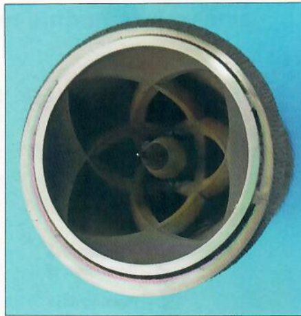
Bild 2: Stirnseite des Mischschlauchkopfs mit der durch zwei Wände geteilten Ringnut, über die sowohl die Stütz- als auch die Kühlluft vom Flansch in den Mischschlauchkopf überführt wird.
