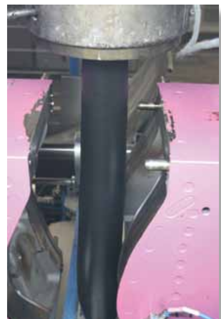
Bild 6 a+b: Abgekühlter, unverstreckter Vorformling mit einer maximalen Wanddicke von 9,5 mm und einer minimalen von 6 mm (linkes Bild) sowie aus der Düse ausgetragener Vorformling kurz vor dem Schließen des Werkzeugs (rechtes Bild)
