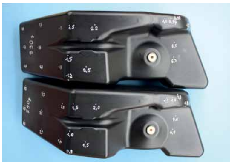
Bild 7: Vergleich der Wanddickenverteilung zwischen dem konventionell hergestellten Behälter (Gewicht 990 g) und dem mit der nachgerüsteten GWDS-Düse gefertigten Behälter (Gewicht 790 g) (Werkbilder: Dr.-Ing. Heinz Groß, Kunststoff-Verfahrenstechnik, Roßdorf)
