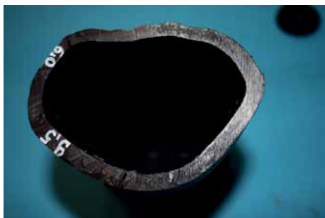
Bild 6 a+b: Abgekühlter, unverstreckter Vorformling mit einer maximalen Wanddicke von 9,5 mm und einer minimalen von 6 mm (linkes Bild) sowie aus der Düse ausgetragener Vorformling kurz vor dem Schließen des Werkzeugs (rechtes Bild)
