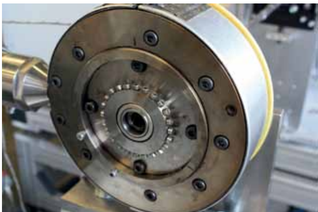
Bild 3: Quer angeschlossener Schlauchkopf mit Flexringhülse und stufenlos verstellbarem Austrittsspalt
