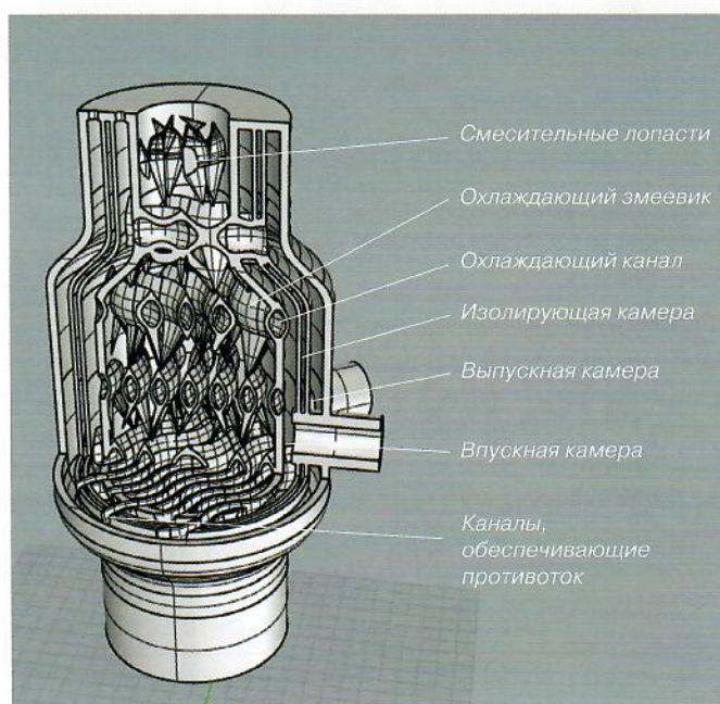
Рисунок 1. Конструкции охладителя расплава, изготовленного по технологии селективного лазерного плавления в разрезе
