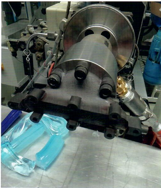
Рисунок 4. Фильтры для исследований, присоединенная к охладителю расплава, с шестиугольной решеткой в проточном канале на выходе фильеры
