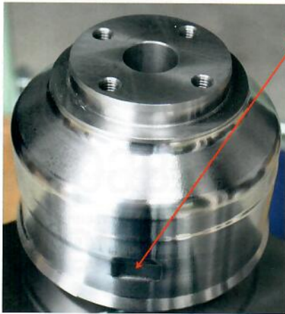
Рис. 2. Для получения требуемой толщины стенки 1 мм в начале резьбы заливной горловины канистры при использовании конического проточного канала необходимо значительно увеличить толщину стенки по всей окружности и по всей длине горловины
