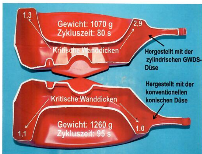
Рис. 5. Оптимизация фильеры для изготовления прицепа для машинок Bobby Car
