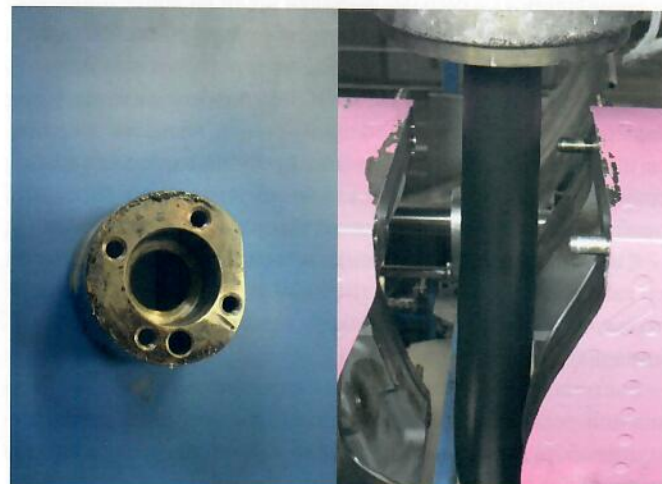
Рис. 4. Профилирование дорна для бачка стеклоомывателя (слева), прямая (без волн) заготовка для изготовления бачка (справа)
