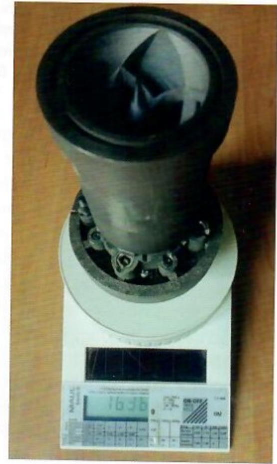
Bild 3: Kopfgewicht gemessen mit einer Briefwaage
