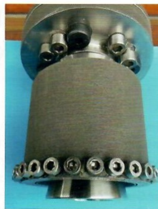
Bild 7: Konischer Dorn, der zur Einstellung des maximal möglichen Düsenspalts weit aus der Düse herausgefahren wurde
