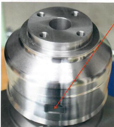
Bild 2: Um die geforderte Wanddicke von 1 mm am Beginn des Einfüllgewindes des Kanisters zu erreichen, muss man mit einem konisch gestalteten Fließkanal die Wanddicke über den gesamte Umfang und über die Länge des Einfüllstutzens extrem vergrößern
