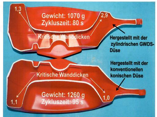
Bild 5: Optimierung der Düse für den Bobby Car Anhänger
