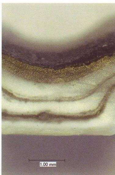
**Рис. 2. На сделанном под микроскопом снимке поперечного сечения области соединительного шва формованной детали видно, что в новой смесительной зоне раздувной головки расплав делится на несколько слоев, которые в стенке детали накладываются друг на друга, и границы между ними исчезают**
