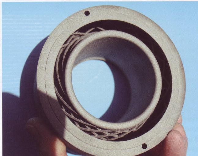
Рис. 1. Новый смеситель, встроенный в раздувную головку после канала распределения расплава (фото: Gross Kunststoff-Verfahrenstechnik)
