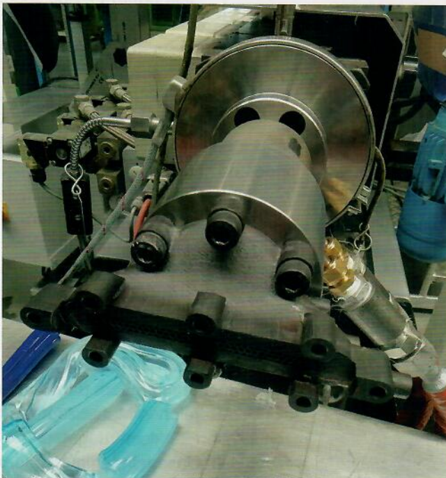
Bild 4: An den Schmelzekühler angeflanschte Forschungsdüse mit einem hexagonalen Fließkanalgitter am Düsenende (Werkbilder: Dr.-Ing. Heinz Groß)
