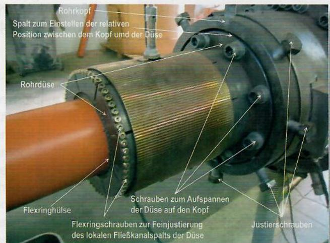
Bild 2: Rohrkopf mit einer Flexringdüse und einer konventionellen Justiervorrichtung
