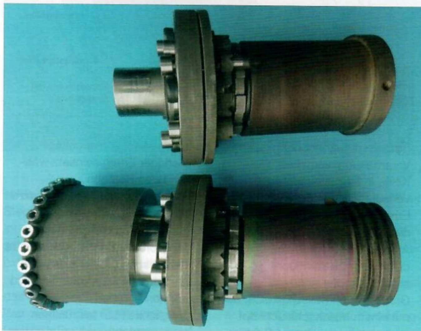
Bild 1: Zwei generativ hergestellte Mischschlauchköpfe für zwei Kunden, die entsprechend der unterschiedlichen Anforderungen des jeweiligen Kunden, konzipiert worden sind
