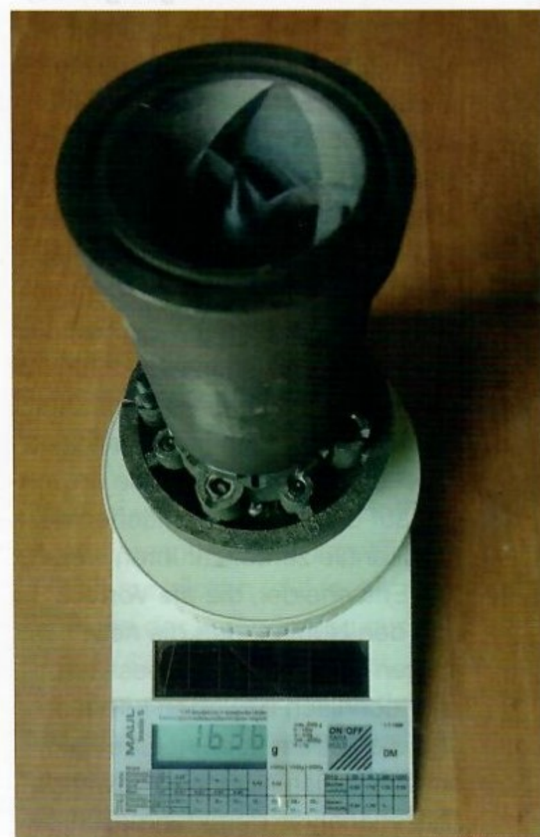
Bild 3: Gewicht des Mischschlauchkopfs gemessen mit einer Briefwaage
