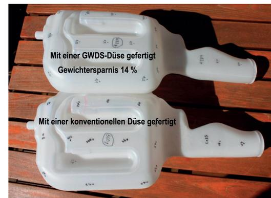
Bild 13 a-c: Beispiele von Formteilen, bei denen die Wanddickenverteilung lediglich durch den Austausch der konventionellen konischen Düse durch eine zylindrische GWDS-Düse erheblich verbessert werden konnte, wodurch eine beachtliche Gewichtsabnahme und eine Reduktion der Zykluszeit erreicht wurde (Werkbilder 7-9 und 11-13: Dr.-Ing. Heinz Groß Kunststoff-Verfahrenstechnik, Roßdorf)
