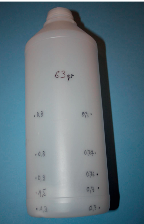
Bild 5: „Verfahrensbedingte“ Wanddickenunterschiede im unteren Bereich einer einfachen runden Flasche, die mit einer konventionellen konischen Düse hergestellt worden ist
