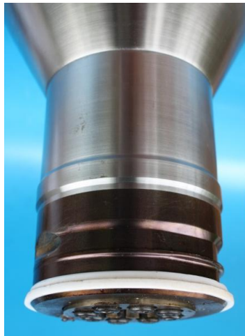
Bild 4 Aus einzelnen unterschiedlich profilierten Dornscheiben aufgebauter vorrangig zylindrischer Dorn, der an beiden Enden nahezu den gleichen Durchmesser besitzt
