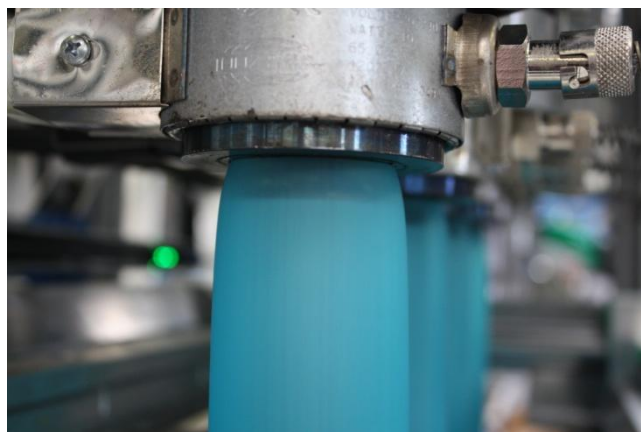
Bild 8 Mit GWDS-Düsen (Düsendurchmesser 40 mm) nachgerüsteter Vierfachkopf mit den im Inneren der Vorformlinge erkennbaren Dornen, die weit aus den Düsen herausgefahren sind
