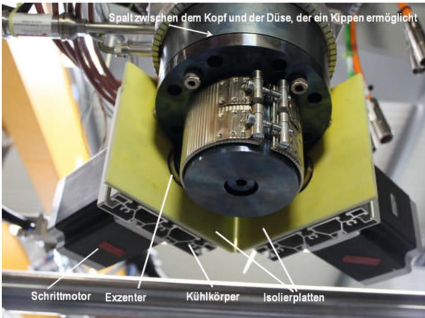
**Bild 4. GWDS-Düse mit metallischem Kippgelenk und zwei Schrittmotoren, die mittels spezieller Isolierplatten von der Wärme des Kopfes abgeschirmt sind**
