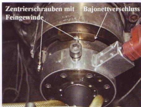
kippen, was natürlich eine viel feinfühligere Zentrierung ermöglicht und in letzter Konsequenz dazu führt, dass die Düse genauer positioniert werden kann.
