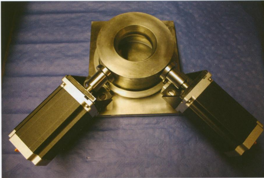
Bild 1: Kippdüsenmodell, bei dem die Trennebene zwischen der Düse und dem Kopf (bzw. der Grundplatte) mit einem Gummiring abgedichtet wird, der zum Kippen der Düse über zwei im Winkel von 90 Grad angeordneten Schrittmotoren mehr oder weniger gestaucht wird
