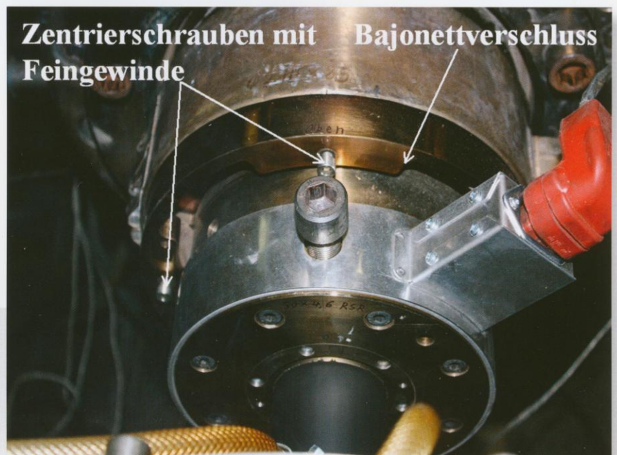
Bild 2: Rohrkopf, dessen Düse mit einem Bajonettverschluss auf den Kopf aufgespannt ist, und bei dem die Düse über spezielle Feingewindeschrauben, die eine Steigung von nur 0,5 mm besitzen, verstellt wird
