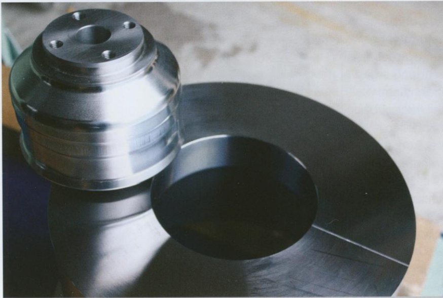
Bild 3: 3D Düse und 3D Dorn, wobei die Düse einen exakt zylindrischen Austrittsbereich besitzt und der Dorn aus einzelnen Scheiben aufgebaut ist, die eine komplexe dreidimensionale Geometrie besitzen
