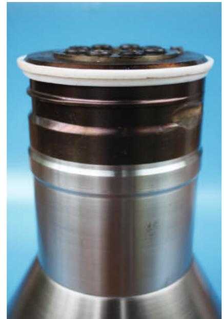
**Bild 5. Aus einzelnen unterschiedlich profilierten Dornscheiben aufgebaute zylindrischer Dorn, der an beiden Enden den gleichen Durchmesser besitzt**
