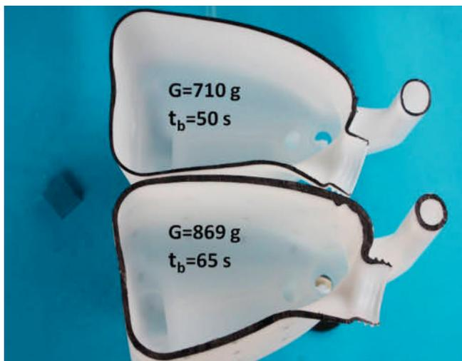
**Bild 6. Wanddickenverteilung eines aufgeschnittenen Kraftstoffbehälters, der mit einer konischen (unten) und einer zylindrischen (oben) Düse hergestellt worden ist [G = Gewicht;  $t_b$  = Blas- bzw. Kühlzeit]**
