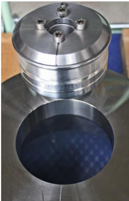
**Bild 4. Düse mit zylindrischem Austrittsbereich und zugehörigem profilierten Dorn, der mit Ausnahme des kurzen konischen Endbereichs vorrangig zylindrisch ist und der um 180° gedreht zu seiner normalen Einbauposition auf der Düse abgelegt ist**
