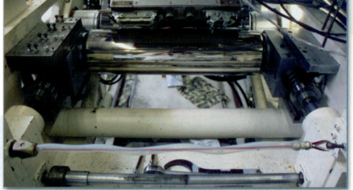
Die getestete Walze war mit einer Ballenbreite von 780 mm noch relativ klein. Das Bild zeigt die in das Versuchsglättwerk eingebaute Walze. Aufgrund der überzeugenden Testergebnisse ist momentan der Bau zweier größerer Glättwalzen mit flexibler Oberfläche in der Planung
