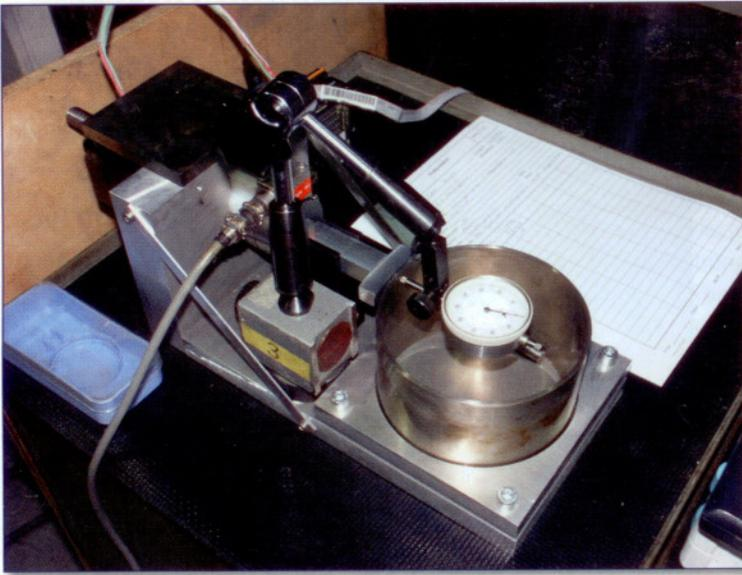
**Bild 4: Vorrichtung zur dynamischen Prüfung einer Flexringhülse (Foto MPA, TU Darmstadt [1])**
