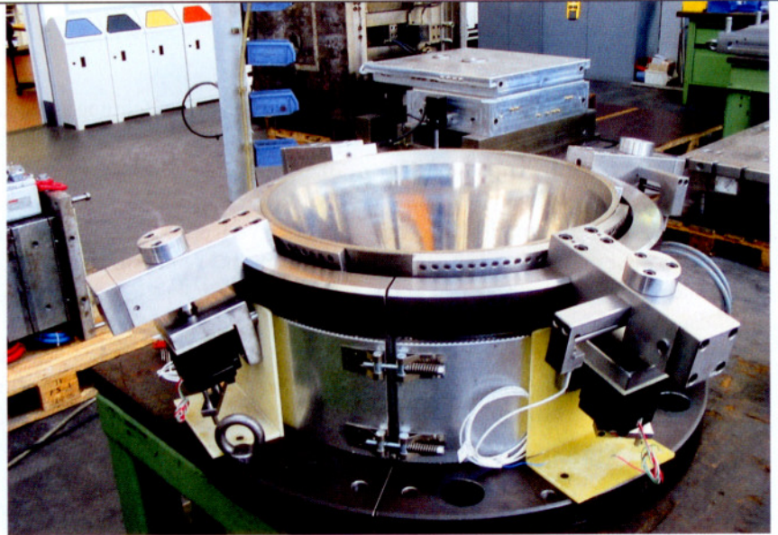
3 Düsenteil eines Flexringblasformwerkzeugs, bei dem mithilfe von vier Linearantrieben, an deren Ende sich jeweils ein Stellbacken befindet, die Flexringhülse bei jedem Austragszyklus dynamisch verformt werden kann
