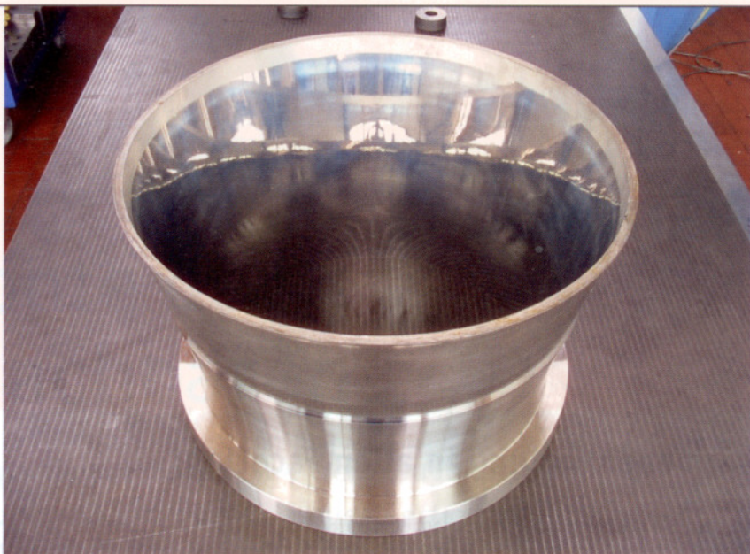
2 Einstückige partiell mehrwandige Flexringhülse aus einer korrosionsfesten Speziallegierung, die einen einwandigen dicken Flansch besitzt und die im konischen Teil aus 20 Einzelwänden besteht
