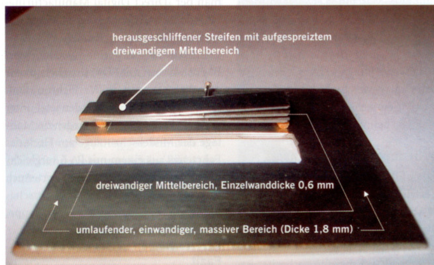
1 Partiell mehrwandige, einstückige Platte mit einem zur Verdeutlichung des dreiwandigen Mittelteils herausgeschliffenen Streifen (links) und Querschnittszeichnung der Platte (rechts)
