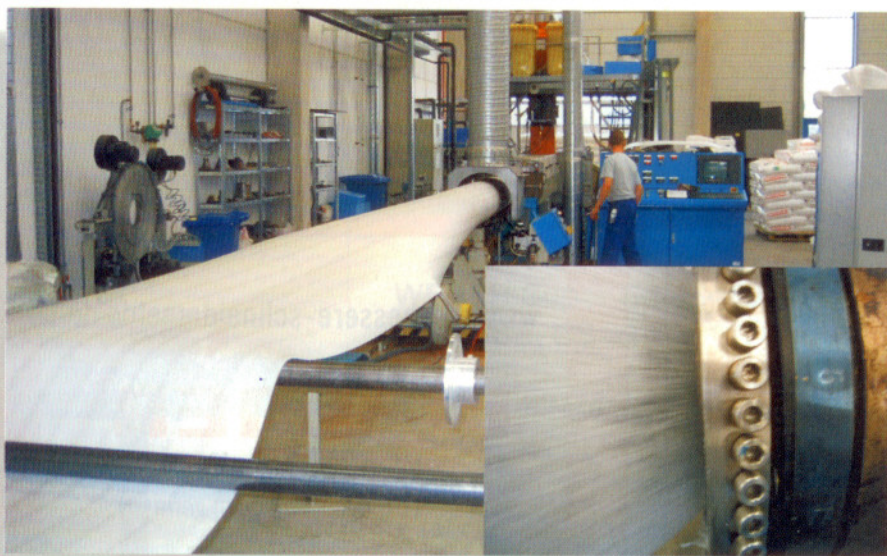
Bei dieser Anlage zum Herstellen geschäumter Platten ist zur Erprobung ein Flexringwerkzeug installiert.
