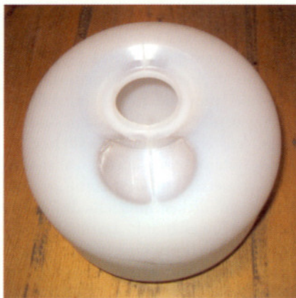
Bild 4. Blasgeformte Flaschen mit extremer Dünnstelle, die zu Demonstrationszwecken durch kurzfristiges lokales Zustellen des Fließkanalspalts am Werkzeug mit Hilfe des Stellbackens erzeugt worden ist
