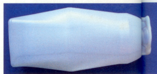
Bild 6. Mit dem Versuchswerkzeug hergestellte Flasche mit variierenden Querschnittsgeometrien (Foto: IKV)
